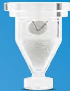
Ячейка для таблеток 22.6 мм со стеклянными шариками и держателем таблетки
