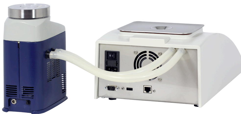
Рис. Обратная сторона DR6000 с подключенным термостатом
