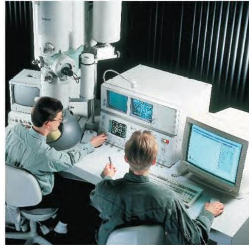
**Принципиальное строение светового микроскопа и трансмиссионного электронного микроскопа.** На данном рисунке отмечено сходство внутреннего устройства микроскопов. Стеклянным линзам светового микроскопа в электронном микроскопе соответствуют магнитные катушки. В электронном микроскопе необходимо, чтобы образец находился в вакууме. На фотографии показан рабочий трансмиссионный микроскоп.
