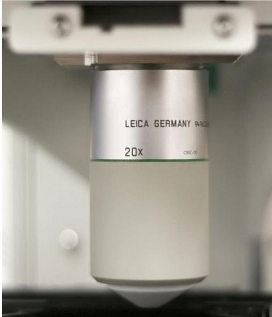
Этот объектив имеет керамическую нижнюю часть, рабочее расстояние 2 мм и угол доступа  $39^\circ$  (это позволяет удобно проводить микроманипуляции с препаратом).
