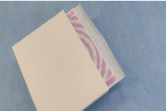
Тест-пакет "Бови-Дик-" предназначен для контроля оборудования, оценки производительности стерилизатора на полноту удаления воздуха из стерилизационной камеры.
