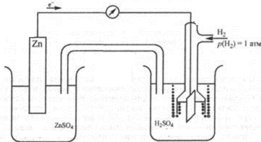
Потенциал измеряют в электрохимической ячейке, состоящей из **стандартного и индикаторного электрода**, на котором происходит электрохимическая реакция восстановления или окисления компонента редокс-пары.
